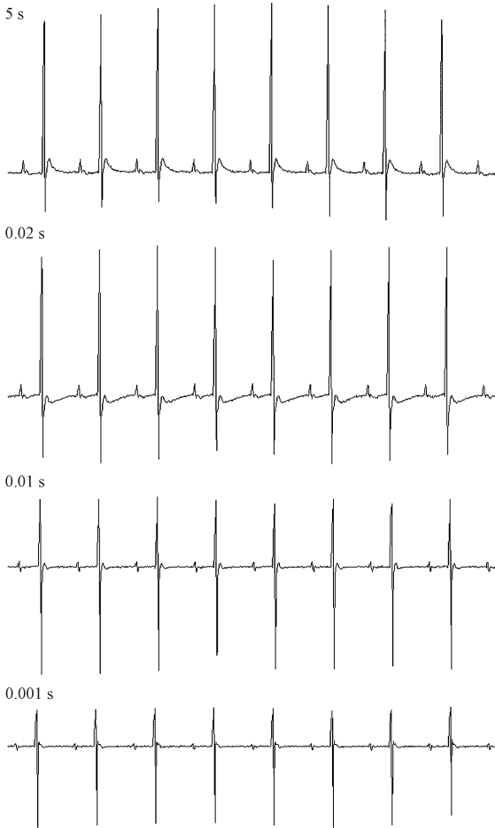
图 3 时间常数对心电图波形的影响
